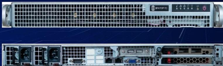
Изделие DIONIS-CE предназначено для криптографической защиты информации, передаваемой по высокоскоростным каналам связи на скорости 100 Гб/с.
